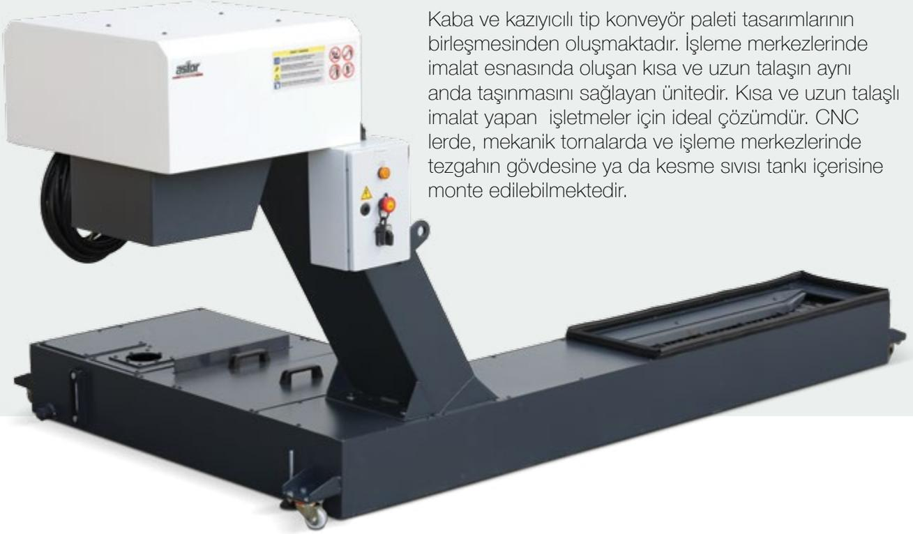
Kaba ve kazıyıcı tip konveyör paleti tasarımlarının birleşmesinden oluşmaktadır. İşleme merkezlerinde imalat esnasında oluşan kısa ve uzun talaşın aynı anda taşınmasını sağlayan ünedir. Kısa ve uzun talaşlı imalat yapan işletmeler için ideal çözümdür. CNC lerde, mekanik tornalarda ve işleme merkezlerinde tezgahın gövdesine ya da kesme sıvısı tankı içerisine monte edilebilmektedir.
